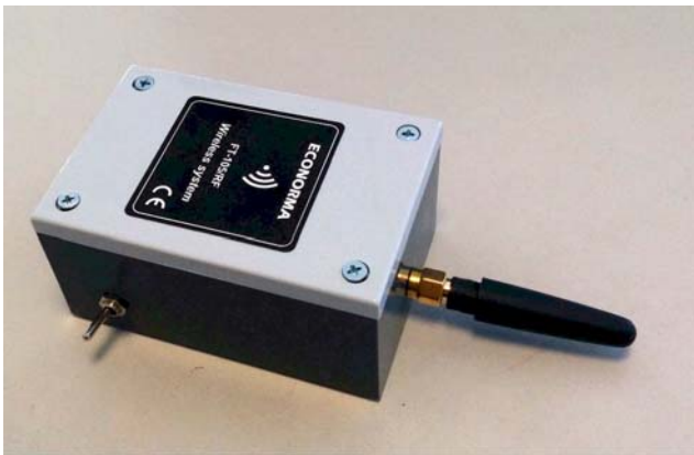
Modulo radio con interruzione della alimentazione della batteria
