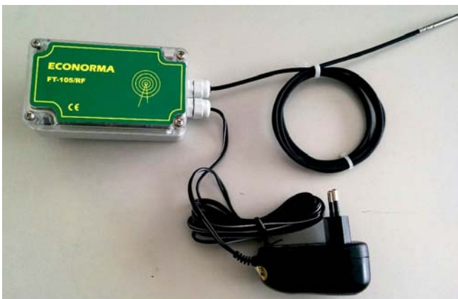
Modulo radio monocanale con alimentazione esterna 12 V.
