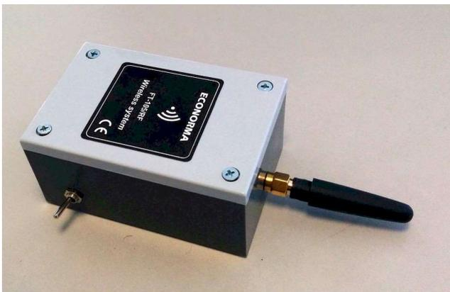
Modulo radio di Temperatura con interruzione On/Off della alimentazione della batteria
