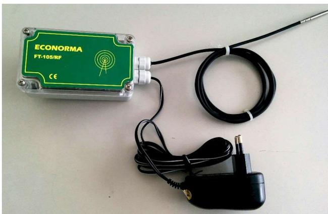
Modulo radio monocanale di Temperatura con alimentazione esterna 12 V.
